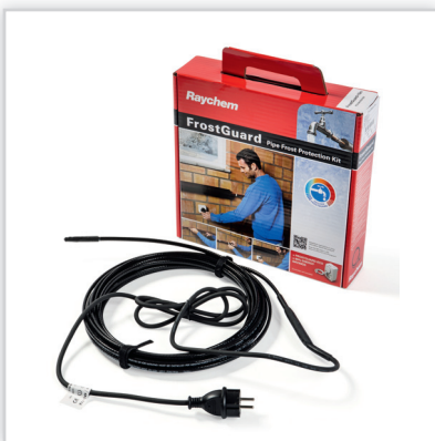
FROSTGUARD. Samoregulujący, zakończony fabrycznie przewód grzejny do ochrony rur przed mrozem; do montażu wewnątrz i na zewnątrz rur. Moc jednostkowa [W/m]: 10 w temp. +5°C (w metalowej rurze), 20 w temp. +5°C (w wodzie).
