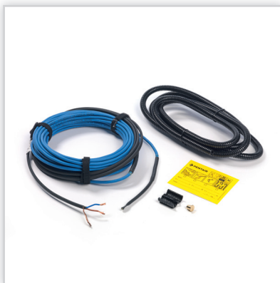
T2Blue. Jednostronnie zasilane, stałooprowe, uniwersalne przewody do ogrzewania podłogowego, układane w warstwie posadzki samopoziomującej, w łazienkach, na schodach, tarasach, oranżeriach. Moc jednostkowa [W/m]: 10 i 20.
