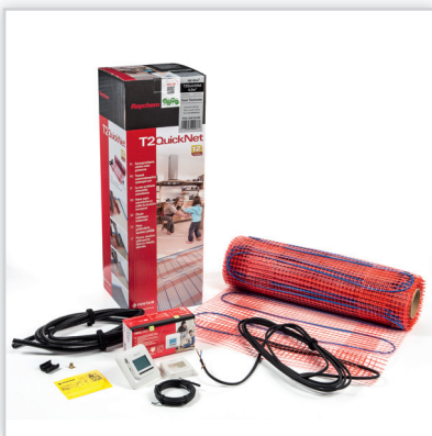
T2QuickNet. Jednostronnie zasilane, samoprzylepne maty grzejne do ogrzewania podłogowego pod posadzkami ceramicznymi; dzięki niewielkiej grubości (3 mm) stanowią bardzo dobre rozwiązanie przy remontach i modernizacji pomieszczeń. Moc jednostkowa [W/m 2 ]: 90 (dla dobrze zaizolowanych podłóg), 160 (do szybkiego nagrzewania lub większych wymagań temperatury).
