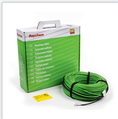
T2Green. Jednostronnie zasilane, stałooprowe, uniwersalne przewody do ogrzewania podłogowego układane w warstwie posadzki samopoziomującej. Zaprojektowany z myślą o dobrze zaizolowanych podłogach w domach pasywnych. Moc jednostkowa [W/m]: 5.
