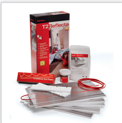
T2Red. Samoregulujący przewód do ogrzewania podłogowego – nie przegrzewa się, może być bezpiecznie instalowany pod każdym rodzajem posadzki. Moc jednostkowa [W/m]: 15 w temp. +25°C. T2Reflecta – do podłóg drewnianych i paneli podłogowych – przewód T2Red w zestawie z rowkowanymi płytami izolacyjnymi T2Reflecta, które minimalizują straty ciepła, a cienka warstwa aluminiowa zapewnia równomierny rozkład temperatury w pomieszczeniach.
