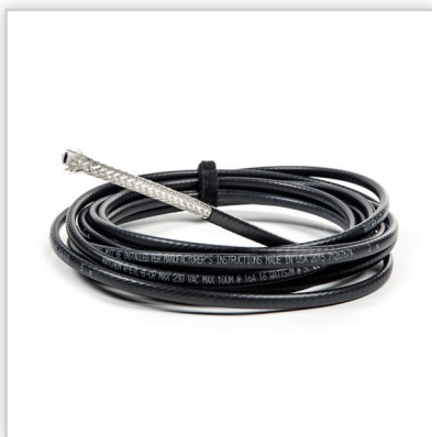
ETL. Samoregulujący system o małej średnicy do ochrony rur przed zamrażaniem – stosowany na zewnątrz oraz wewnątrz rur z wodą. Moc jednostkowa [W/m]: 10 w temp. +5°C (ETL-A, ETL-A-CR), 16 w temp. +5°C (ETL-B, ETL-B-CR).
